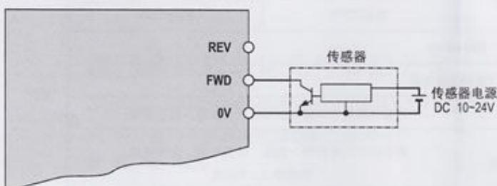
FWD、REV采用接近开关、光电开关等传感器控制
